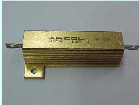
Figure III-A-11. Résistance de puissance montée sur radiateur métallique
