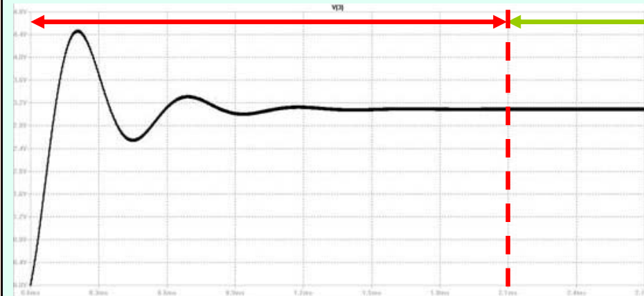
Figure I-C-3. Régime transitoire et régime permanent dans un convertisseur
